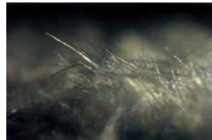
Microscopisch kleine, naaldachtige kristallen vullen de van nature voorkomende poriën en capillaire holtes van het beton wat resulteert in gegarandeerd waterdichte constructies.
